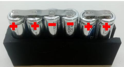
2.- Poner el termistor en la tira de 20mm en medio de las dos baterías (+) (+) y colocarle pasta para soldar.
