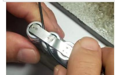
5.- Sacar las baterías de la fixture y voltear las baterías. Doblar los hilos que sobresalen del cable
