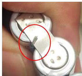
6.- Colocar pasta para soldar y soldar los hilos del cable negro en medio de la tira de 20mm entre las dos baterías (-) (-). Esto se puede hacer fuera o dentro de la fixture.
